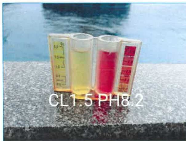
ภาพถ่ายที่ 3.4.3-1 การตรวจเช็คค่าความเป็นกรดต่างและคลอรีนอิสระคงเหลือของสระว่ายน้ำประจำวัน
